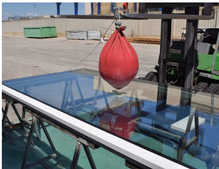
Prova all'urto di corpo molle in cantiere
